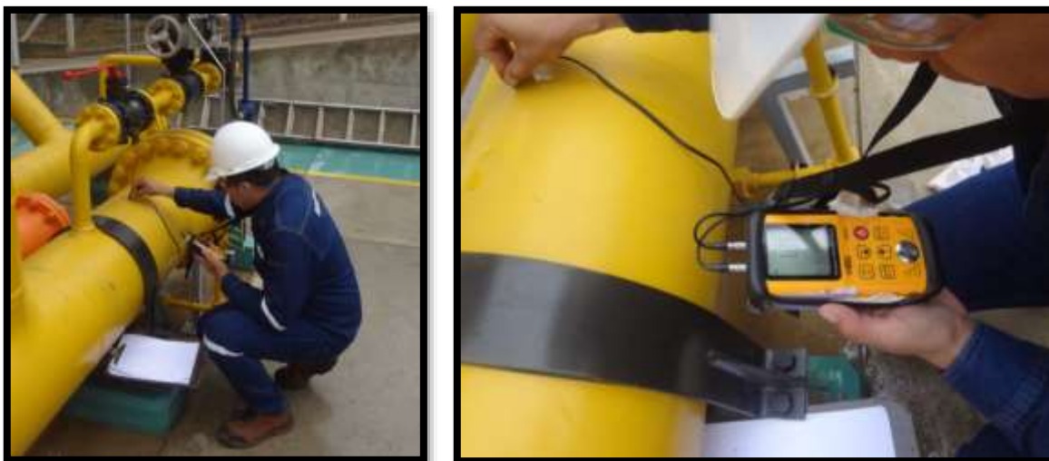
Figura 3. Ejemplo real medición de espesores.
